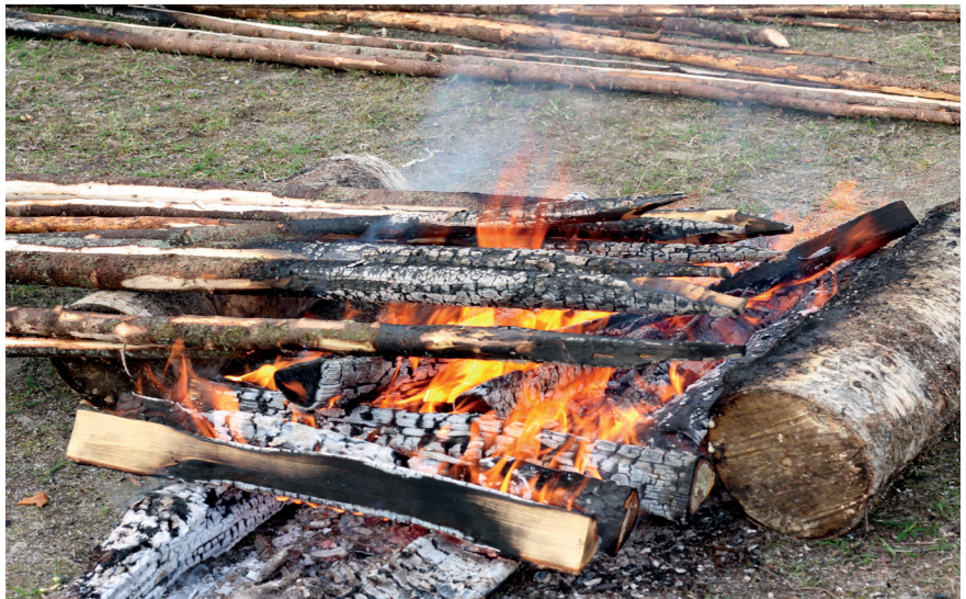
Seipäät teroitetaan ja hiilletään noin puolen metrin matkalta. Hiillostus parantaa kestävyyttä.
