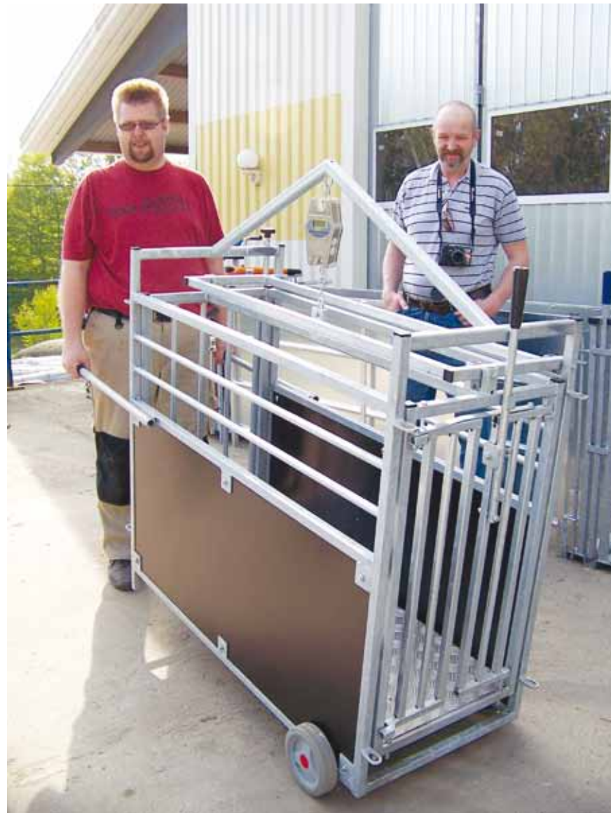
Daniel Green näyttää Timo Heikkilälle, kuinka LG-Produkterin vaakoja voidaan siirtää laitteen runkoon kiinteästi sijoitettujen ulosvedettävien aisojen ja kumipyörien avulla.
