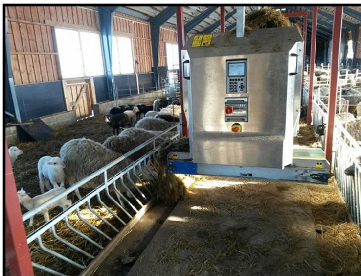
KUVA 11. Karkearehunjakovaunu OTS1600 jakaa lampaille rehua 20 kertaa vuorokaudessa (Herrakunnan Lammas Oy s. a.).
