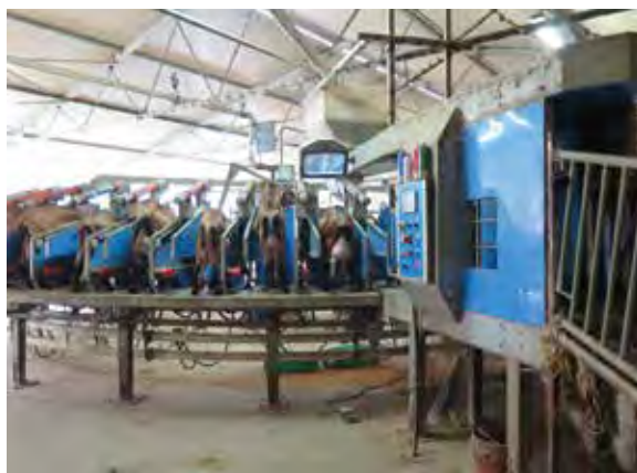
Sisältäpäin lypsettävä 64-paikkainen karuselliasema. 450 kuttua, kaksi lypsäjää, lypsyaika 1 tunti (yläkuva).
