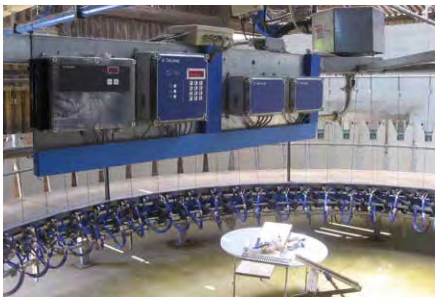
Sisältäpäin lypsettävä 64-paikkainen karuselliasema. 450 kuttua, kaksi lypsäjää, lypsyaika 1 tunti (yläkuva).
