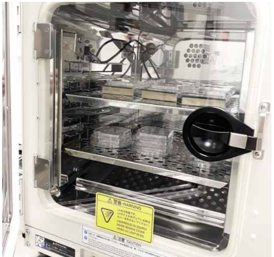
Inkubaattoria eli kasvatuskaappia Luken alkiolaboratoriossa tarvitaan munasolujen kypsyttämiseen ennen koeputkihedelmöitystä ja hedelmöitettyjen munasolujen eli alkioiden kasvatukseen pakastus- tai siirtokelpoiseksi. Inkubaattorin lämpötila pidetään 38,5°C:ssa.
