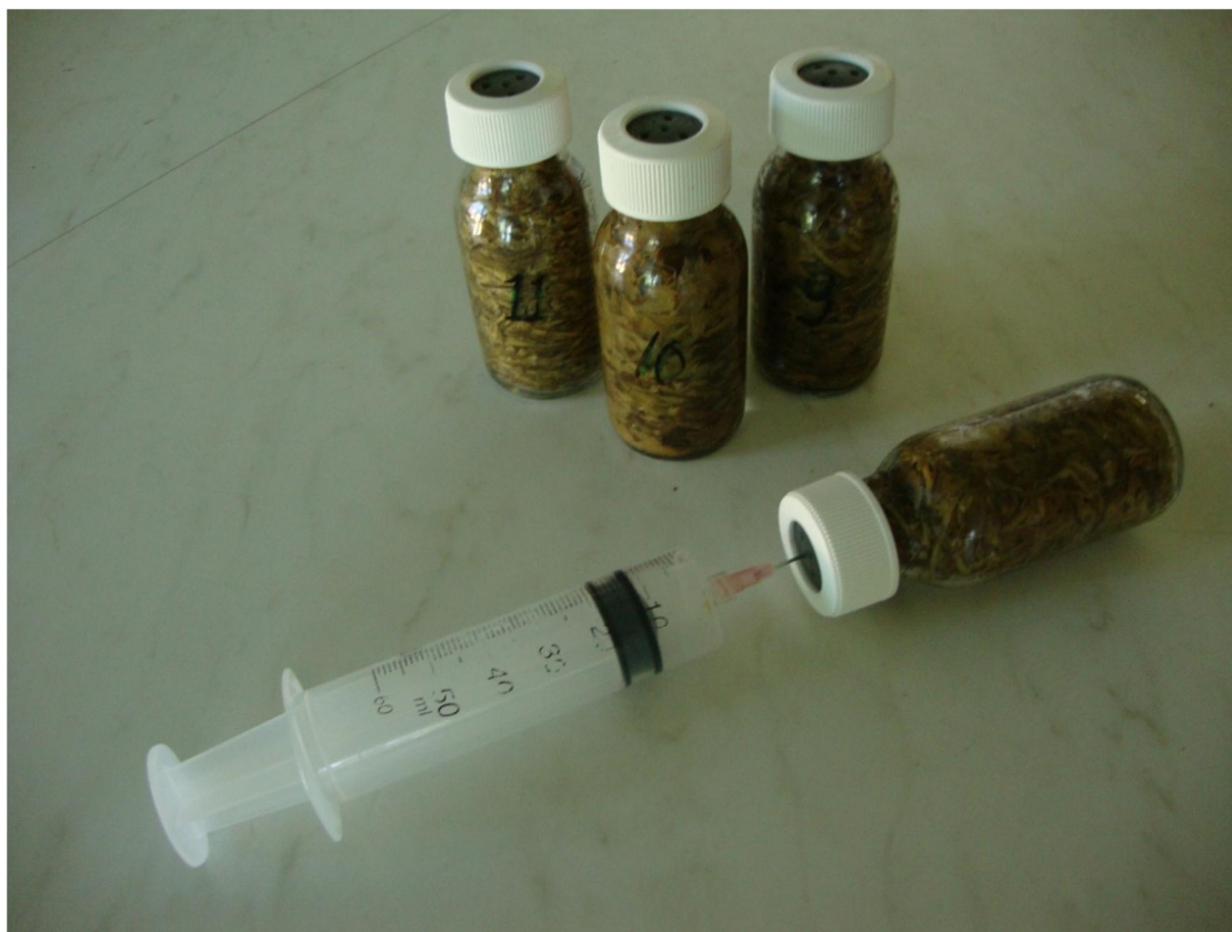
KUVIO 2. Kaasujen mittaus minisiiloista injektioruiskun avulla. Kuva: KARPE-hanke
