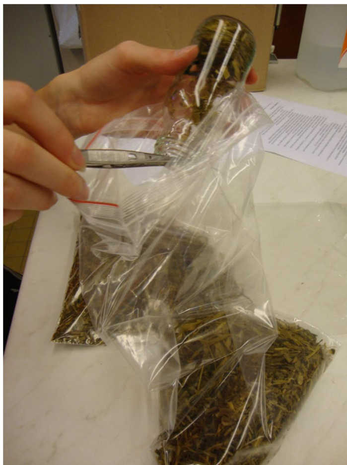
KUVIO 3. Punnitsemisen jälkeen minisiilojen säilörehut tyhjennettiin tiiviisiin muovipusseihin ja näytteet pakastettiin. Kuva: KARPE-hanke
